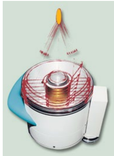
Fig. 1 A e B: a) schema di litotritore con sorgente Rx ed ecografica in linee b) schema del generatore elettromagnetico a bobina inserito nel riflettore acustico
